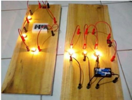
Gambar 11.5 Rangkaian Listrik (Seri dan Paralel)
